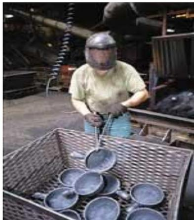
Der Rohling wird aus der Form genommen, der Sand gekühlt und für die Wiederverwendung aufbereitet. Das Produkt hat jetzt noch eine sehr raue Oberfläche und wird nun von Hand für die Emaillierung vorbereitet.
