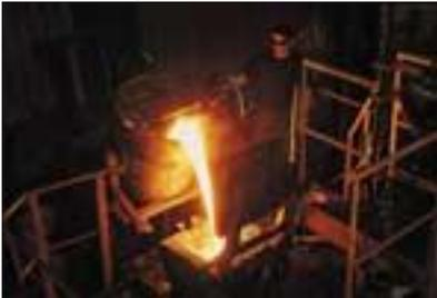
Die Produkte werden aus einem Guss hergestellt inklusive Griffe. Nach dem Gebrauch wird die Form zerstört. Aus diesem Grund sind zwei Le Creuset Produkte niemals identisch und es kann gelegentlich zu leichten Abweichungen kommen. Bei Le Creuset ist jedes Stück ein Einzelstück - ein Unikat.
