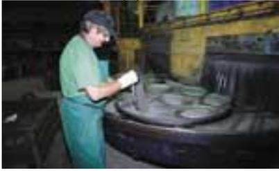
Abschließend werden mit grobem Metallschrott kleine Roststellen entfernt und die Oberfläche aufgeraut, damit die Emaille besser haftet.
