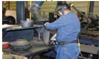
Nun wird der Boden geschliffen, dies ist erforderlich, damit die Spezial-Emaillierung (Vitrobase®/Vitroplus®) gut auf der Bodenoberfläche haftet.
