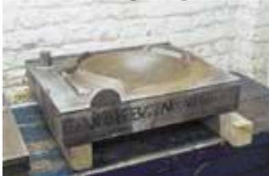
Zunächst werden zwei Modelplatten gefertigt, die mit Sand gefüllt werden. So entsteht eine Sandform, in die das geschmolzene Gusseisen (1340°) gegeben wird.
